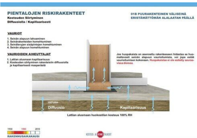
Kuva 44 Riskirakennekortissa havainnollistetaan väliseinän alaohjauspuuhun kohdistuvia vauriomekanismeja.
