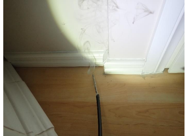
Alakerran lattian ja seinän rajasta tulee vuotoilmaa rakenteista sisäilmaan.
