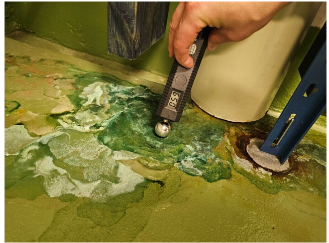
Kuva 114 Tarkastushetkellä välipohjalaatan pintakosteuslukemat eivät olleet koholla.
