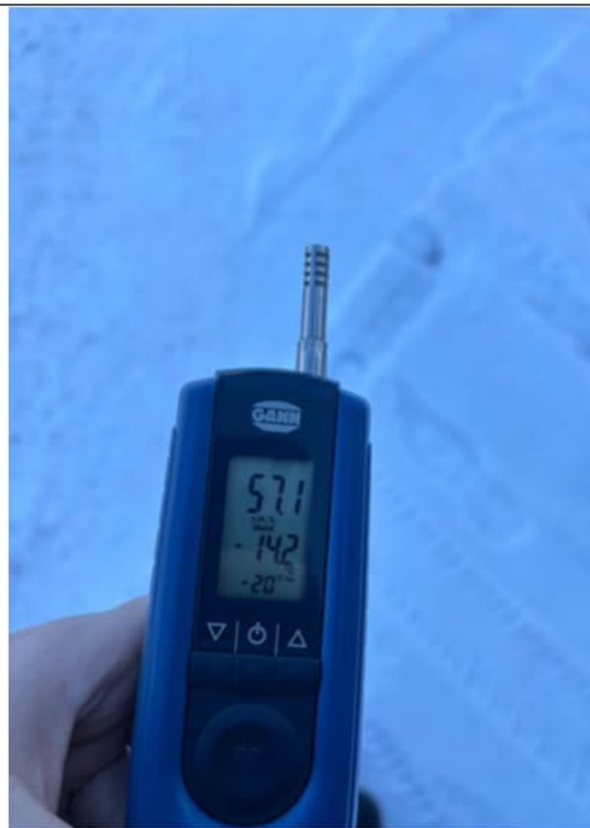
Kuva 1 Ulkoilman suhteellinen kosteus RH oli 57,1% ja lämpötila -14,2 astetta
