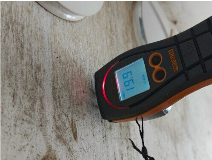
Kuva 64 Seinä puupiikkimittarilla märkä 19,9 paino%, suositus alle 18 paino%
