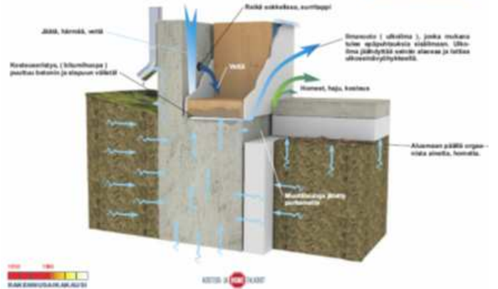
Kuva 13 Tyypik kuva valesokkeli sekä ulkoseinän alaosan ja maapinnan välinen korkeusero vähäinen rakenteiden vauriomekanismista. ( http://hometalkkoot.fi/ tunnista ja tutki riskirakenne)
