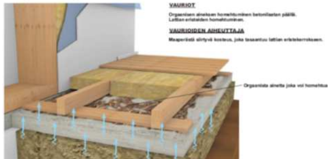
Kuva 13 Periaate puurakenteisen alapohjan vauriomekanismista ERISTÄMÄTTÖMÄN betonilaatan päällä. Tyypikuva ( http://hometalkoot.fi ) tunnista ja tutki riskirakenne)
