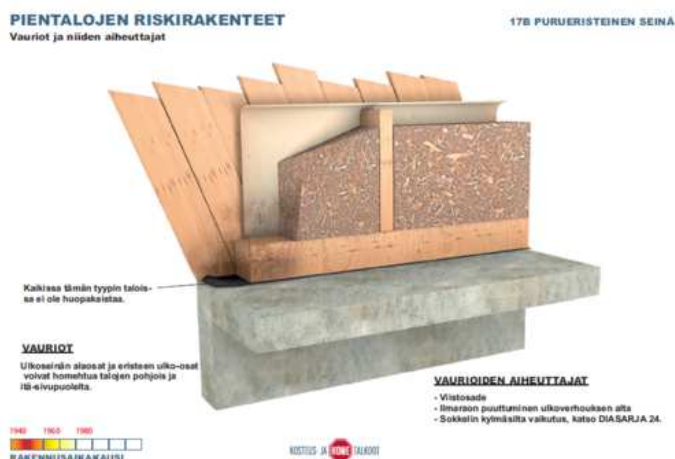
Kuva 21 Tyypikuva alkuperäisestä tuulettumattomasta purueristeseinän vaurioitumisesta ( http://hometalkoot.fi/ tunnista ja tutki riskirakenne)
