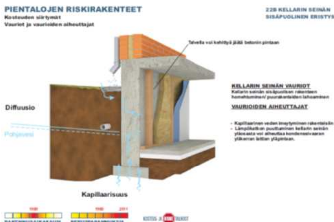
Kuva 5 Tyypikuva maanvastaijen sisäpuolelta villaeristetty kellarin seinärakenne ( http://omakotitalot.hometalkoot.fi/ tunnista ja tutki riskirakenne)
