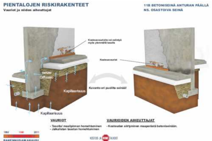
Kuva 4 Periaate kosteuden kapillaarisesta noususta kivirakenteisessa seinässä ja maanvaraisissa betonilaatoissa esimerkiksi kellarissa. Tyypikuva ( http://hometalkoot.fi ) tunnista ja tutki riskirakenne)
