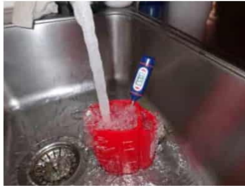
Kuva 37. Lämpimän käyttöveden lämpötilan mittaus.
