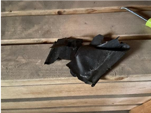
Kuva 10. Saunan seinässä havaittiin PAH(16)-summapitoisuuden ylittävää tervapahvia
