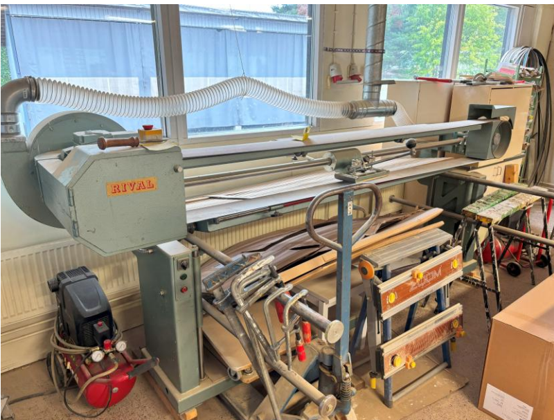
Kuva 6: Lahjoituksena saatu nauhahiomakone, jota ei ole kytketty käyttöön. Työkoneen ympärille ja päälle on varastoitu puristimia ja muuta työssä käytettävää materiaalia, jolle ei ole osoitettu säilytyspaikkaa.
