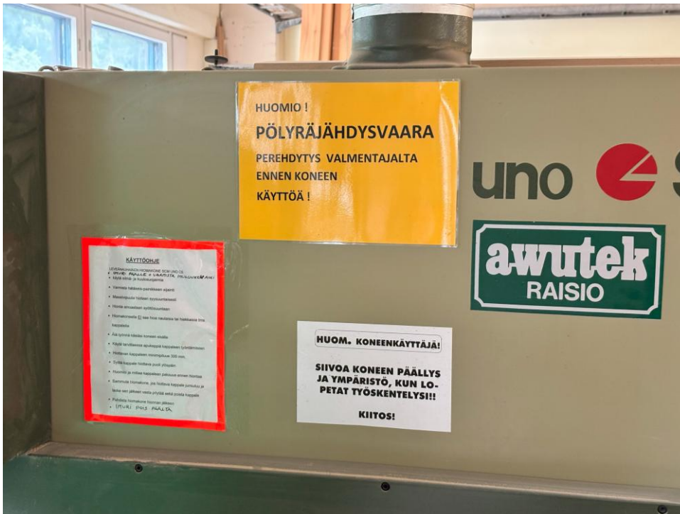
Kuva 3: Leveänauhaisen hiomakoneen kylkeen kiinnitetty laitteen käyttöturvallisuusohje (punainen kehys) ja varoitus pölyräjähdysvaarasta. Käyttöturvallisuusohjetta on täydennetty jälkikäteen lisäämällä ohjeet puruimurin käytöstä.
