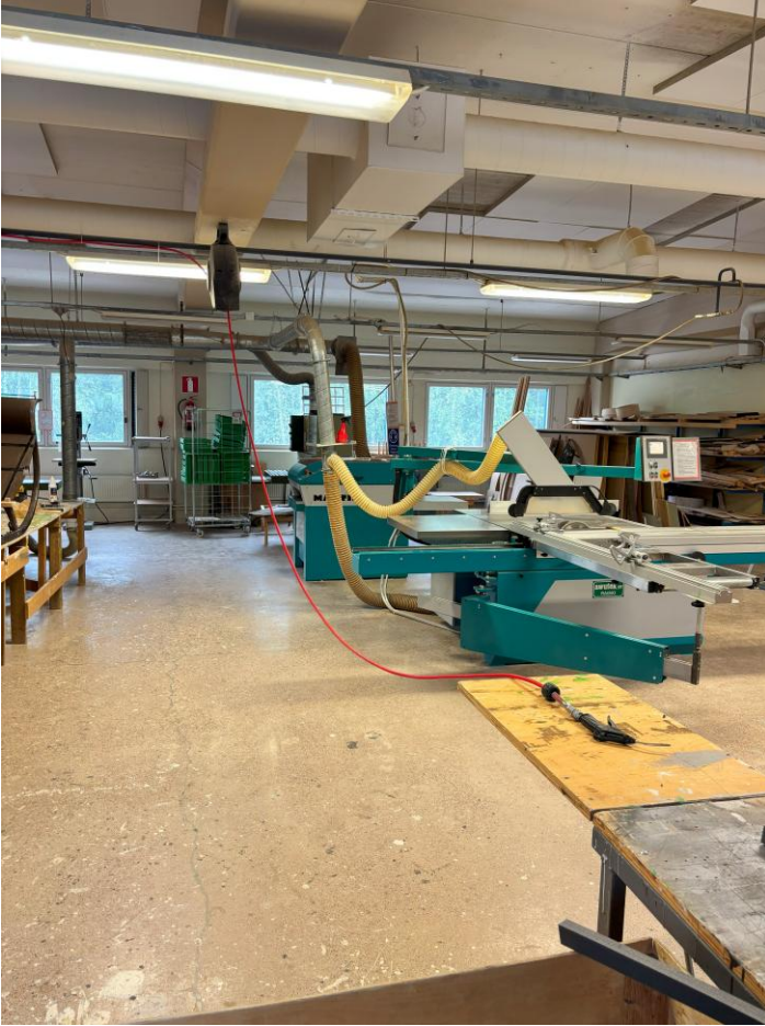
Kuva 5: Paineilmapistooli oli jätetty työpisteelle käytön jälkeen. Automaattikelalla oleva letku roikkui vapaana kulkuväylän yli. Taustalla näkyy käsisammutin, jonka edustalle on varastoitu metallirullakko.
