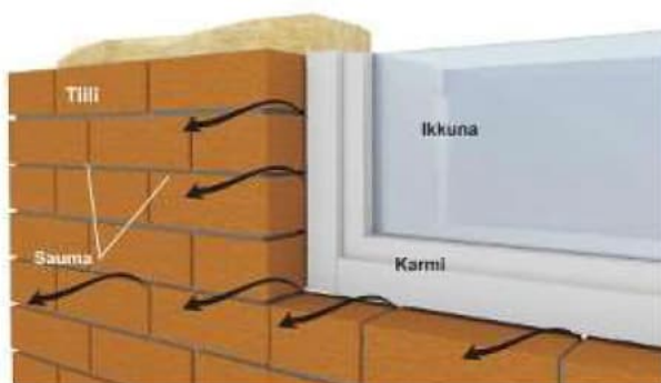
Kaaviokuva tiilitalon ulkoseinän ilmvuodoista.
