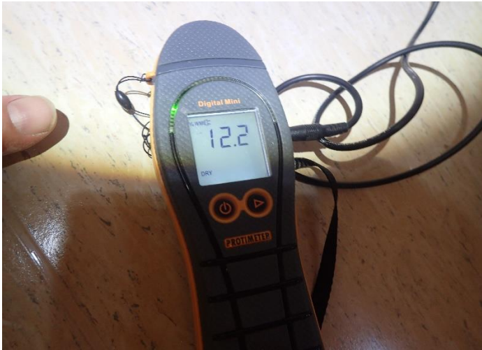
Alaohjauspuusta ei todettu kohonneita kosteuskertoimia piikkimittarilla.
