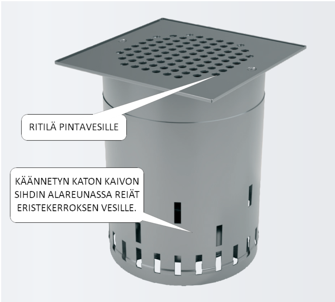
Kuva 22. Käännetyin kattorakenteen kaivon sihti
