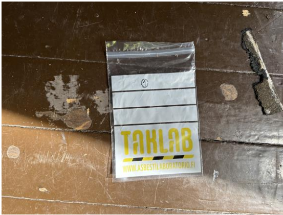
Kuva 10 ja 11. 2.kerroksen ruskea lattiamaali sisältää raskasmalleja.
