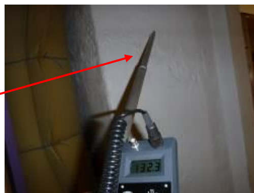
Kuvat 53 ja 54. Kantava pilarin yläosasta todettiin korkeita kosteuslukemia.
